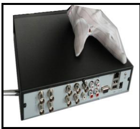
①拆卸主机上盖的固定螺丝
