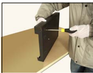
④安装固定硬盘螺丝
