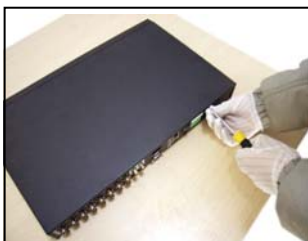
①拆卸主机上盖的固定螺丝
