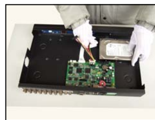
⑥连接硬盘电源线
