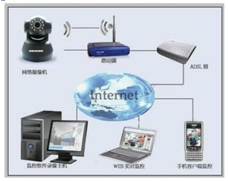
连接网络摄像机到 10 / 100M 自适应集线器或交换机,用双胶线一端的水晶头轻轻插入摄像机尾部的以太网卡接口上,另一端接路由器或交换机,连接正常时,RJ45 网络接口指示灯闪烁。
